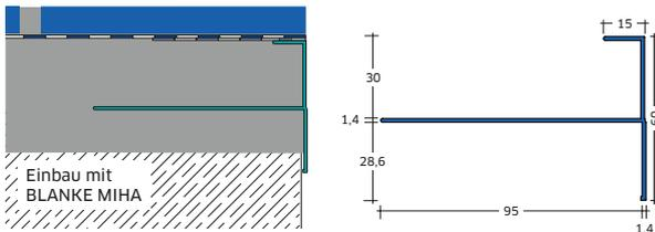
Blanke MIHA ist ein pulverlackbeschichtetes Aluminium-Abschlussprofil, mit dem der Querschnitt des Estrichs oder der Konstruktionsaufbau abgedeckt werden kann. Gleichzeitig dient das Profil beim Einbau des Estrichs als Schalung und Abziehhilfe. Zur Abdeckung von Stößen und Ecken stehen die Blanke MIHA-Verbindblende und Blanke MIHA-Außen-eckblende 90° zur Verfügung.
