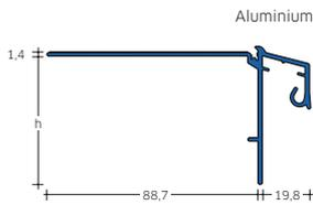
BLANKE BALKON BP ist ein Abschlussprofil zur Aufnahme der beiden Systeme BLANKE RINSYS-R und BLANKE RINSYS-E und dient als Basisprofil für das in der Höhe variable, drainagefähige Profil BLANKE AF. Zusätzlich kann es für Beschichtungen eingesetzt werden. Das Produkt wird durch Verbinder und Außen- sowie Innenecken komplettiert.
