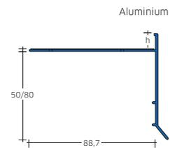
Der Blanke BALKON-Abschlusswinkel ist ein Balkonprofil in Fliesenabschlussausführung. Das Profil wird im System ohne Drainage mit Blanke DIBA verlegt und durch Verbinder und Außen- sowie Innenecken komplettiert.
